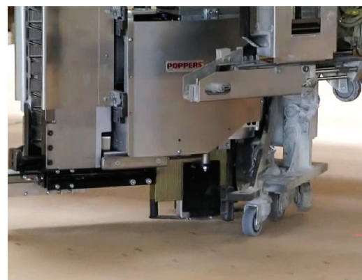
Figuur 1.10 HighLoad Stapler 65 De SHLS65 kan met 10 nieten per seconden volautomatisch een houtconstructie afwerken. Deze highload tool is voorzien van een behuizing om het product af te werken. Met een demonteerbaar magazijn kan het product snel herladen worden.
