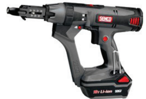
Figuur 1.8: Duraspin Kenmerkend voor de Duraspin bandschroefmachines is capaciteit om een hoog aantal schroeven per minuut ononderbroken te verwerken. Voornamelijk gebruikt om gipsplaat op hout te schroeven.
