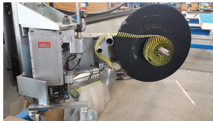
Figuur 1.9: HighLoad Coilnailer 90 In dit figuur staat de SHLCN 90 in gebruik weergegeven. Dit krachtige spijkerpistool kan met coils van 3000 spijkers in een hoog tempo houtconstructies bespijken.
